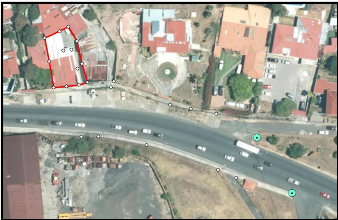
Figura 19. Levantamiento con amarre a puntos leídos de la ortofoto.
