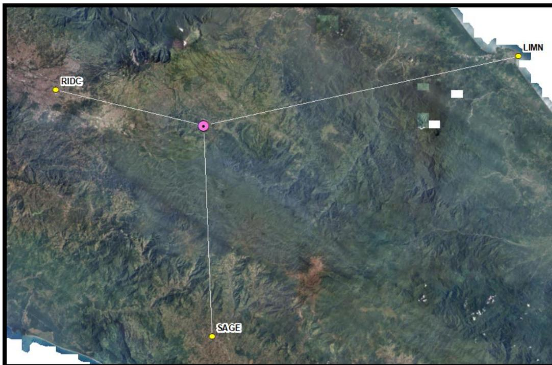
Figura 11. Ejemplo de amarre de punto estático a la Red de Estaciones de Medición Continua de Costa Rica.
