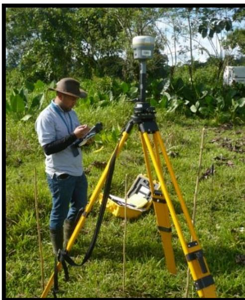
*Figura 9. Estación de medición GNSS ubicada en campo.*
