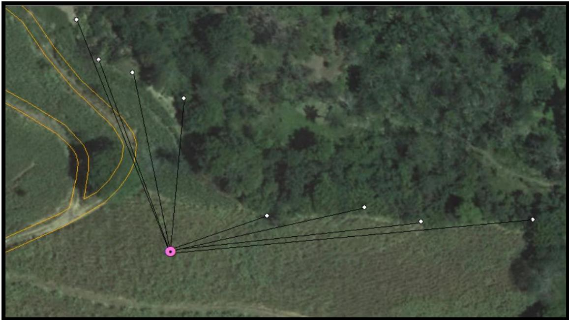
Figura 13. Parte de los vectores del levantamiento con RTK con ortofoto 1:1000
