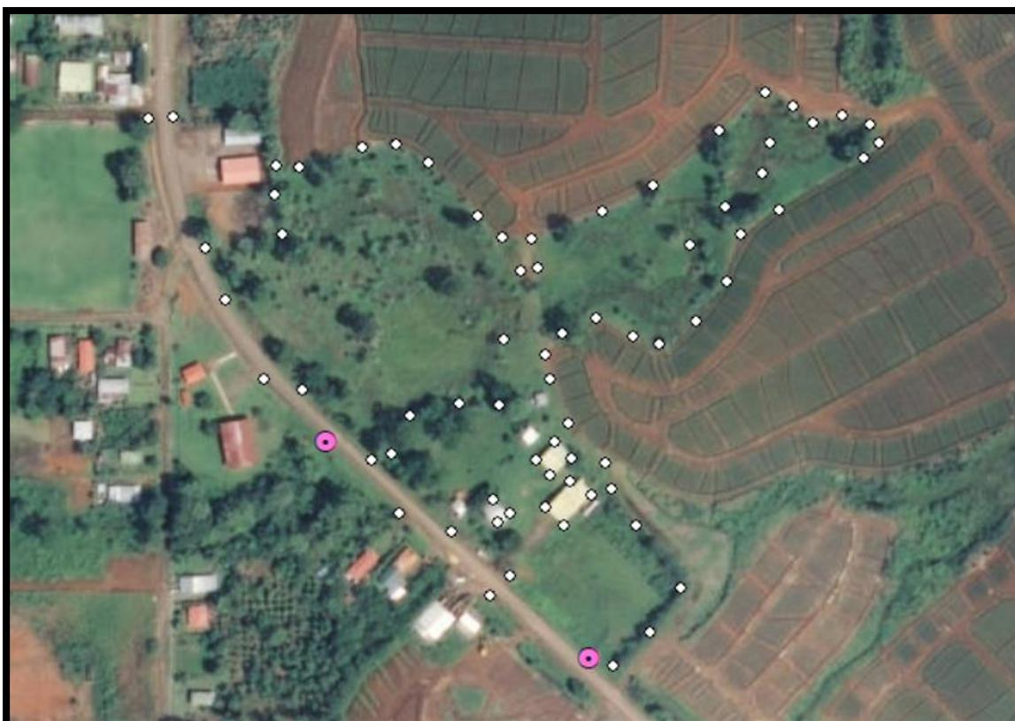
*Figura 15. Levantamiento de detalles con dos puntos de amarre.*
